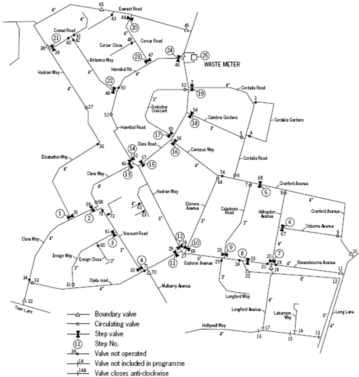
Figura 8.7: Planul unei zone tipice de testare in trepte (Reprodusa din Raportul 26 WAA/WRC)
